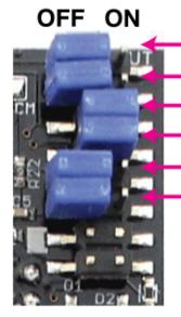
Counting Up/Down Trig/Gate Max-Div-Range 16 Max-Div-Range 32 Spread Off/On Auto-Reset Off/On
