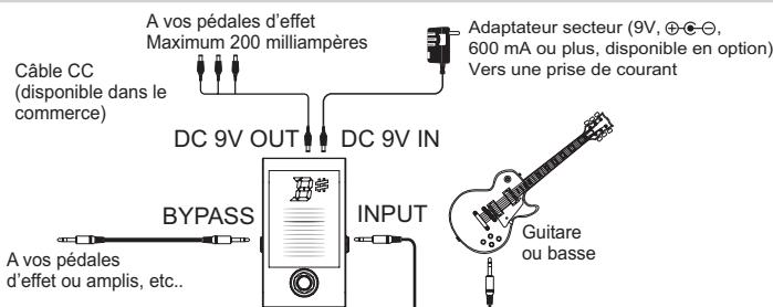
⚠ Mettez tous les appareils hors tension avant d'effectuer les raccordements pour éviter d'endommager votre matériel.
